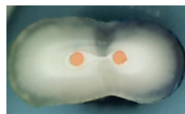
Snímek z optického mikroskopu při zkoušce mikrotěsnosti (kapilární zkouška): Žádné pronikání barviva
